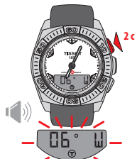
Режим настройки и индикация магнитного отклонения
