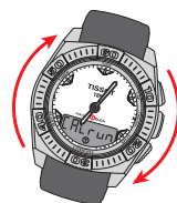
Поверните часы на горизонтальной поверхности (например, на столе) вокруг их оси больше чем на один полный оборот со скоростью вращения приблизительно 30° в секунду. Желательно, чтобы вокруг не было никаких магнитных полей. Общее время: 20 секунд максимум.
