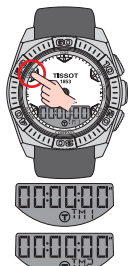
Индикация первого таймера . Нажмите дважды, чтобы перейти ко второму таймеру .
