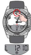
Дисплей показывает время следующего прилива или отлива
